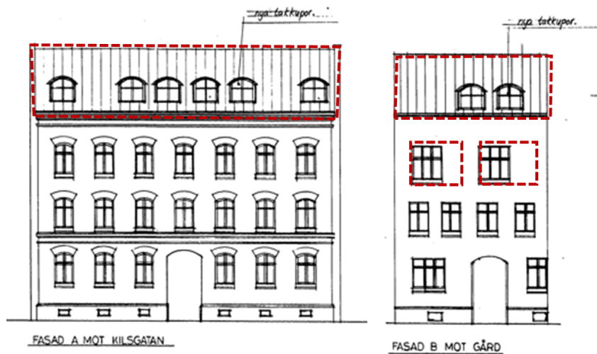
Figur 14: Bygglovsritning från ombyggnationen 1988 som visar ny takbeklädning, förhöjt tak samt tillägg av takkupor mot gata och innergård. På fasaden mot gården syns också förändringar i fönstersättningen, vilken frångår ursprunglig symmetri.
